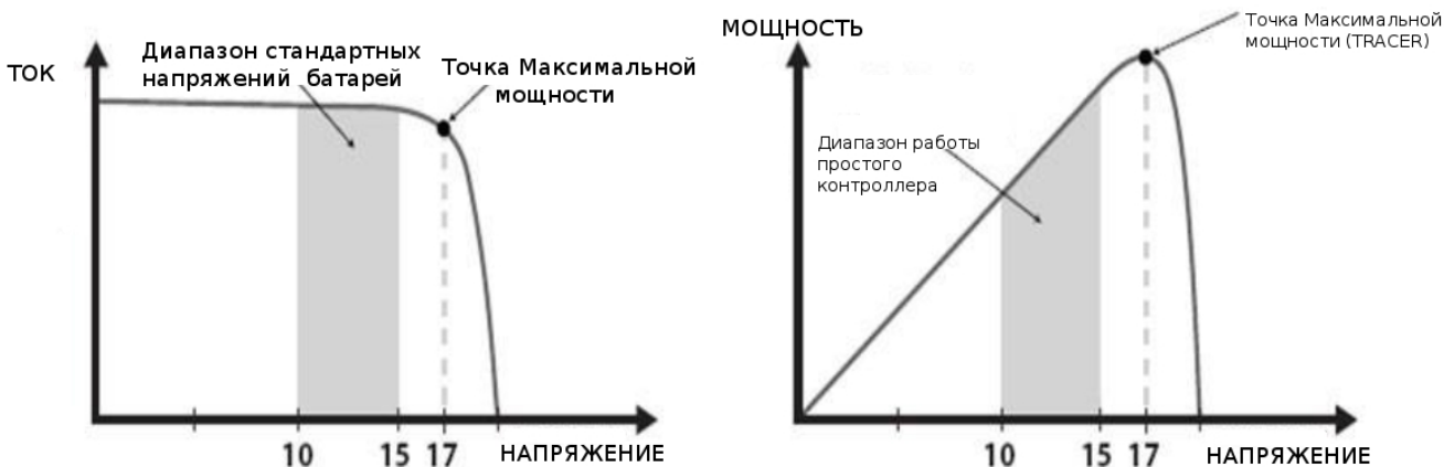
Рис. 4-1 Зависимость силы тока от напряжения для систем с 12-вольтовым номиналом ( I-V)
