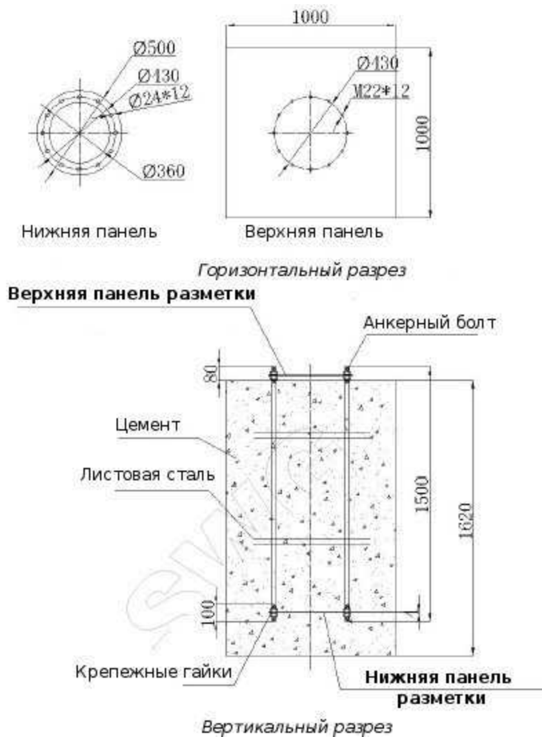
Рис. 4.1 Схема бетонирования опоры для свободно стоящей мачты
