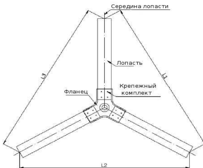
Рис. 3.10 Схема соединения лопастей
