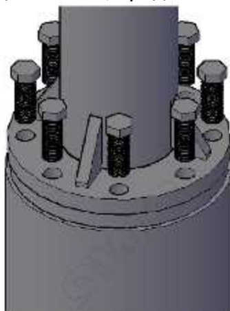
Рис. 4.2 Вид соединения секций свободно стоящей мачты
