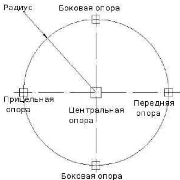
Рис. 3.2 Схема бетонной основы
